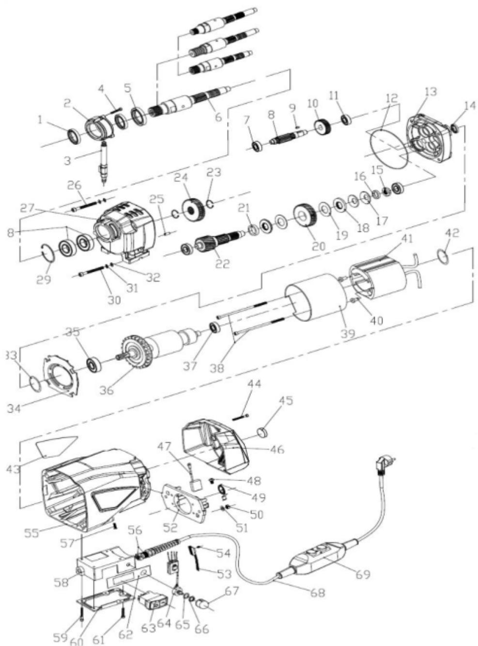
Заказ запчастей осуществляется согласно порядковому номеру, указанному на взрыв схеме станка.
