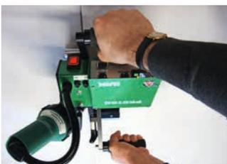
Die kleine und leichte automatische Schweissmaschine zum Verschweissen von allen Dichtungsbahnen. Für Tiefbau- und Tunnelanwendungen. Bürstenloser Antrieb und Gebläse. Kombikeildüse mit Heissluft und Kontakt.
